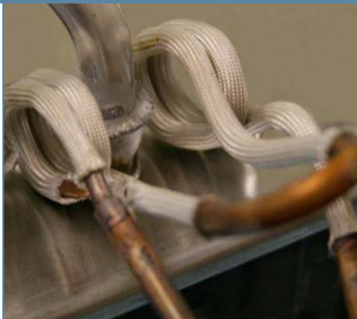
Brasatura di un tubo di alluminio su un radiatore per aria condizionata. Si usano anelli proformati di lega di brasatura contenente il disossidante e un induttore 'split helical' per permettere una facile estrazione del pezzo. 5kW a 260 kHz, 565°C in 12 secondi.
