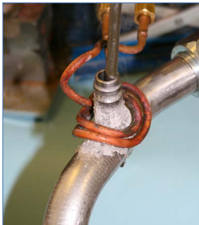
Brasatura di una sfera di acciaio di un regolatore usato nel settore oil&gas. 8kW a 200kHz, 730°C in 9 secondi.
