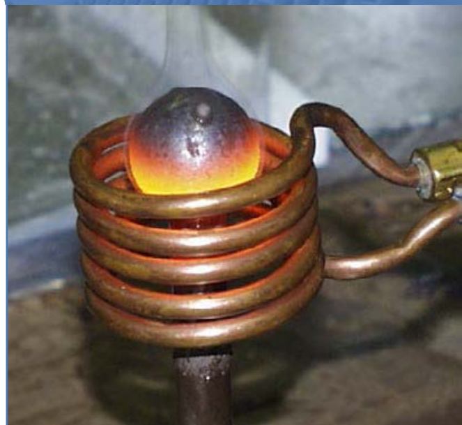
Brasatura di una sfera di acciaio di un regolatore usato nel settore oil&gas. 8kW a 200kHz, 730°C in 9 secondi.
